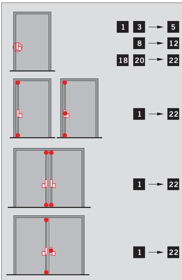
**!** Der Notausgangsverschluss kann bei extremen Türsituationen mit einer Türbreite  $X < 1000$  mm in Verbindung mit dem Abstand des Bandes  $Y > 90$  mm evtl. nicht nach den Standardmaßen montiert werden. Einbauvorschläge stellt DORMA Ihnen auf Anfrage zur Verfügung.
